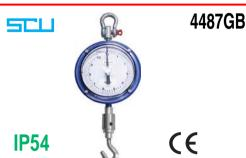
Tipo per misurazioni in trazione e in pressione, di elevata precisione e qualita'. A quadrante graduato con doppia scala in N e Kg. Doppia rilevazione: 1 per la misura continua (Track) - 1 per la misura dei valori di picco (Peak). Pulsante di azzeramento. Fornito con 6 accessori intercambiabili per un utilizzo universale (5 testine + 1 prolunga da mm 90). Incertezza di misura ± 1% del valore massimo.
